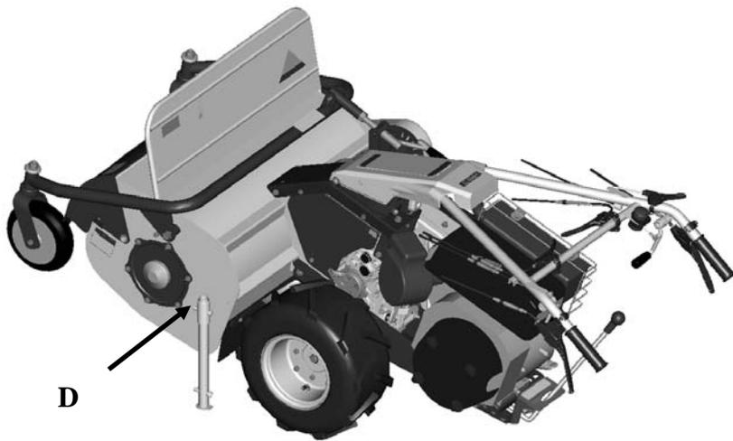
④Dの位置でピンを差込みロータリーカバーを持ち上げた状態で固定します。
