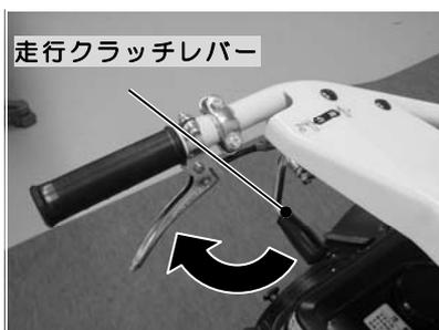
③スロットルを「半開」にし、走行クラッチレバーを「入」位置に引き上げてから、変速レバーを操作すると走行します。
