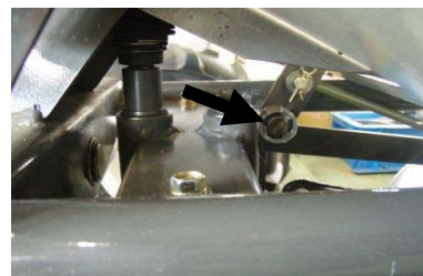
クラッチレールヘッド(1箇所)
