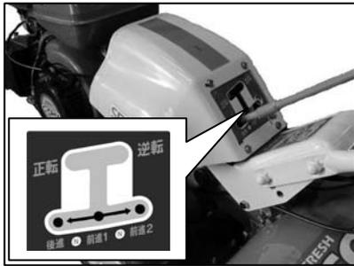
②変速レバーを操作し、所要の変速位置に確実に変速して下さい。
