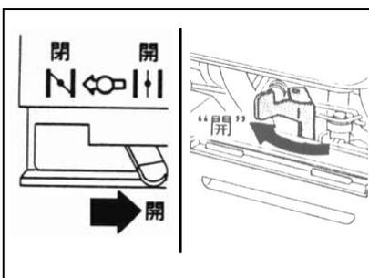
⑨エンジン始動後はチョークレバーを「全開」位置にしてスロットルレバーを低速側「」位置でしばらく(5分程度)の暖機運転を行って下さい。暖機運転を行うことにより、エンジンの各部にオイルを行き渡らせ、エンジンの寿命をのばします。
