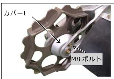
①前輪の草巻き付き防止カバー L を取付けている M 8 ネジをスパナ等でゆるめて取り外します。
