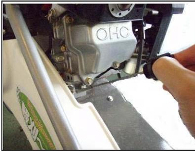
①毎運転前に〈3.1 エンジンオイルの点検〉を参考にエンジンオイルの量、及び汚れを目視で点検し、規定量でない場合、及び汚れがひどい場合には、補給または全量交換（下記参照）してください。
