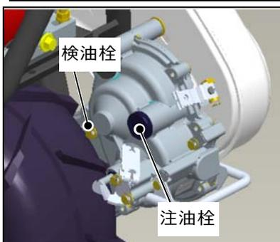
① ミッションケース左側上部の検油栓(検油口)を取外し、検油栓からオイルがにじみ出てきたら、ほぼ規定量のミッションオイルが入っています。
