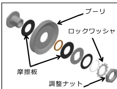
トルクリミッタープーリのトルクは使用することで変化していきます。リミッタの作動で本機が進みにくくなりましたら調整をしてください。
