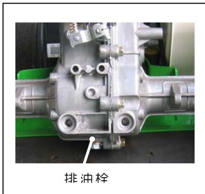
②排油し、ドレンプラグを取り付けた後、ミッションケース上部の注油栓（透明の樹脂）を緩めて取外して下さい。注油口よりミッションオイル（#90）を規定量（1.2 ㍓）入れて下さい。
