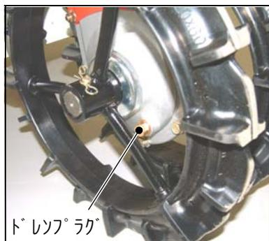
交換は、オイルを受け取る適当な容器を用意し、初回は**20時間目**、それ以降は**100時間目**を目安にミッションケース左側面下部のドレンプラグ(排油栓)を外して行って下さい。
