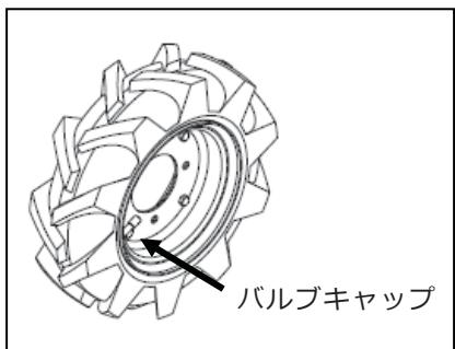
バルブキャップを取り外してタイヤの空気圧を点検し、標準値でない場合は調整を行ってください。
