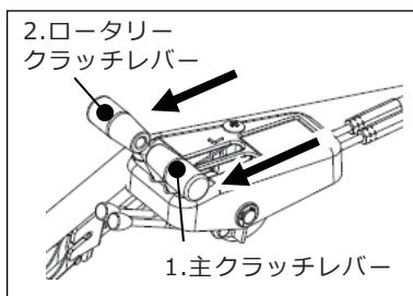
④スロットルレバーを「」位置にして、ロータリークラッチレバー・主クラッチレバーの順に「入」位置にして作業を開始してください。
