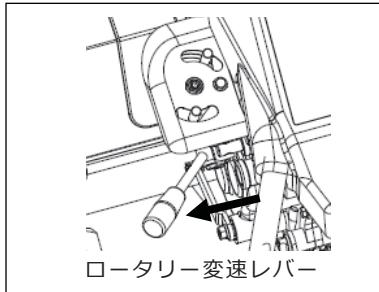
④ロータリー変速レバーを「低速」位置に確実に入れてください。
