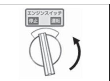
③エンジンスイッチを回して「停止(OFF)」位置にし、エンジンを停止してください。
