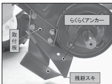
標準で装着されている「取付板」に、製品に同梱されている「残耕スキ」を、左図を参考にボルト・ワッシャーで確実に取り付けてください。
