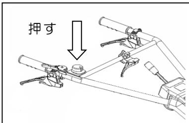
⑫スロットルレバーを低速「」位置にし、エンジンスイッチを押して「停止(OFF)」位置にして下さい。
