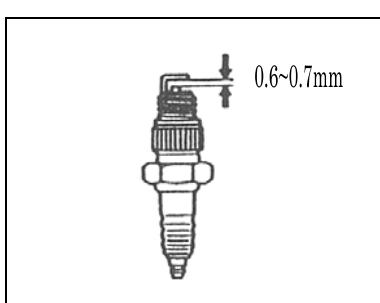
⑤点火プラグの両電極を紙やすりで磨いた後、電極隙間が基準値になるように調整して下さい。
