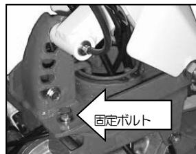
■ハンドル左右の調整は、固定ボルトを外した後、ハンドル中央のレバーを握り行ないます。ハウス内での支柱際の畝立作業や、果樹園での枝下作業時等に、作業し易い位置に調整します。
