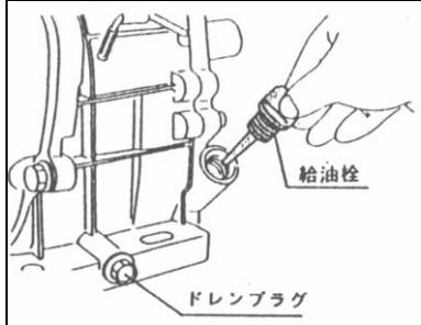
①毎運転前に〈10頁…エンジン始動のしかた〉を参考にエンジンオイルの量、及び汚れを目視で点検し、規定量でない場合、及び汚れがひどい場合には、補給又は全量交換（下記参照）して下さい。
