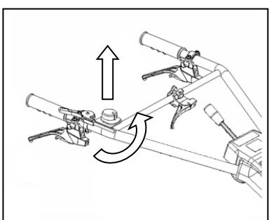
⑥エンジンスイッチを「運転(ON)」位置に回して、引き上げて下さい。
