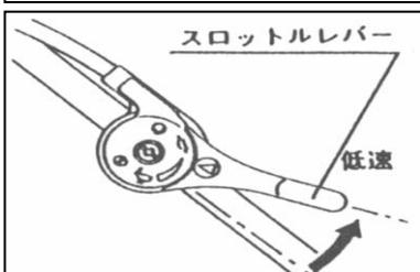
⑪エンジンが始動したら、スロットルレバーを低速側「」位置にして下さい。
