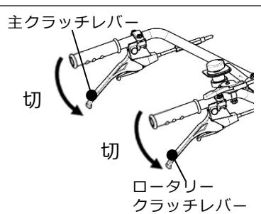
①ロック解除レバーを押して、主クラッチレバー及びロータリークラッチレバーを共に「切」位置にしてください。
