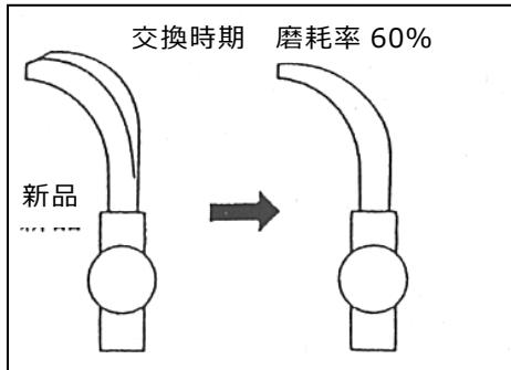
耕うん爪・溝掘爪は始業前に必ず損傷・曲がり及び摩耗を点検してください。また、爪取付部のガタがないかも点検し、もし弛みがあれば増し締めをしてください。
