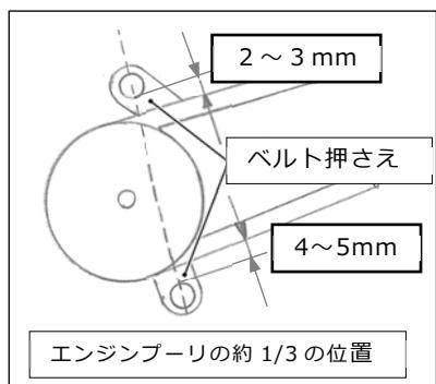
主クラッチレバーが「入」位置のとき、ベルトとベルト押さえの間隔が上側で約 2~3 mm、下側で約 4~5 mm 程度になるようベルト押さえの位置を調整してください。
