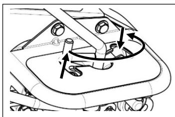
⑤ 変速レバーを「中立(N)」位置にし、そのまま引き上げて変速レバーを反転させます。反転後は手を離し、変速レバーを左右に振って「カチッ」と音がしてチェンジガイドに入ったことを確認してください。
