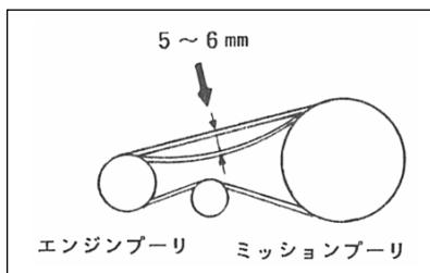
主クラッチレバーが「入」位置の時、ベルト中央部を軽く指で押してみて 5~6mm 程度のたわみがあれば正常です。
