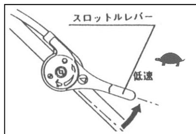
①スロットルレバーを低速「」位置にし、エンジンスイッチを「停止(OFF)」位置にしてエンジンを停止してください。
