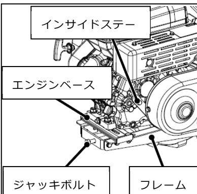
適正なベルト張力の目安は、ベルト中央部を軽く指先で押した時にベルトがおののおの 15 ~ 20 mm程度たわむのが正規です。上記範囲以外でベルトがたわむ場合には以下の要領で正規のベルト張力に調整してください。
