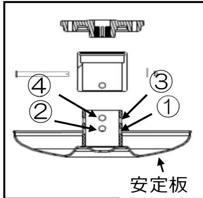
①刈り取り条件に合わせて、安定板の高さを平頭ピンを差替えて調整してください。
