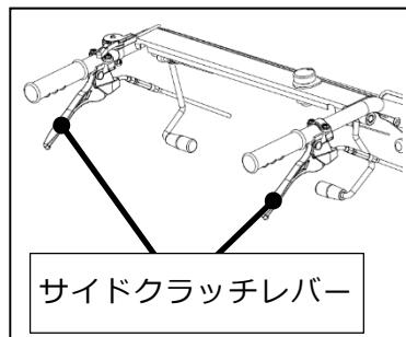
①旋回する側のサイドクラッチレバーを握り、旋回方向と反対側ハンドルを振るように旋回してください。
