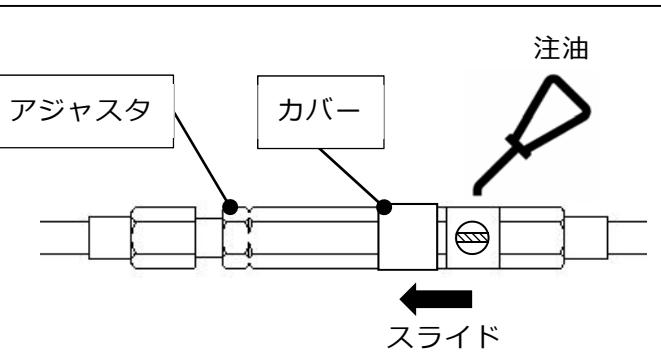
参考；ワイヤの注油は左図を参考に、ワイヤのアジャスター部にあるカバーをスライドさせ、カバーの下にある注油口から注油してください。
