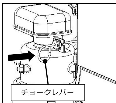
⑦エンジン始動後はチョークレバーを戻し、チョーク弁を「全開」位置にしてスロットルレバーを低速側「」位置でしばらく(5分程度)の暖機運転を行ってください。
