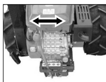
②変速レバーを操作し、「①」「②」「③」「R」の必要な変速位置に確実に入れてください。
