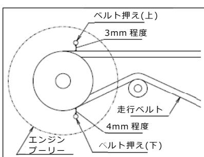
ベルト交換時、またはナイフベルトの調整後は走行ベルトの調整も必ず同時にに行ってください。
