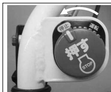
③エンジンスイッチを押して「停止(OFF)」位置にし、エンジンを停止してください。
