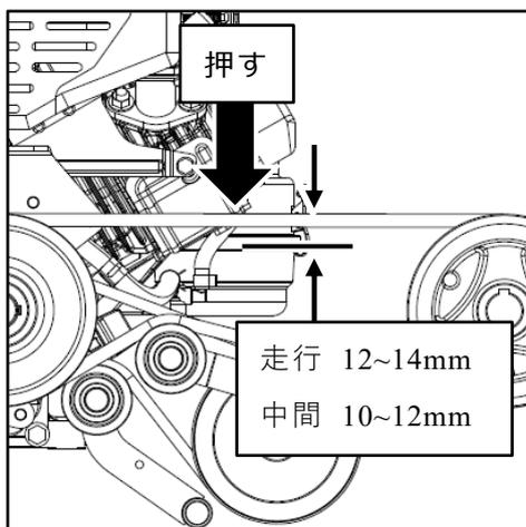
ベルトの交換を行った場合には、左図を参考にベルトの張りの調整をしてください。
