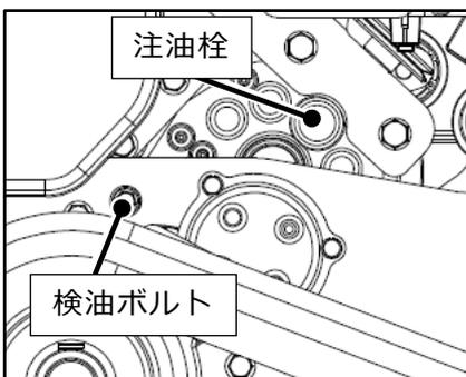
① ミッションケース左側上部の注油栓を取り外し、検油ボルトを緩めてオイルがにじみ出てきたら、ほぼ規定量のミッションオイルが入っています。
