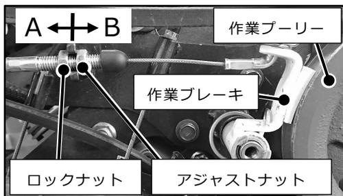
ベルト側(ベルトカバー内側)にある作業ブレーキワイヤのアジャストナットを調整します。
