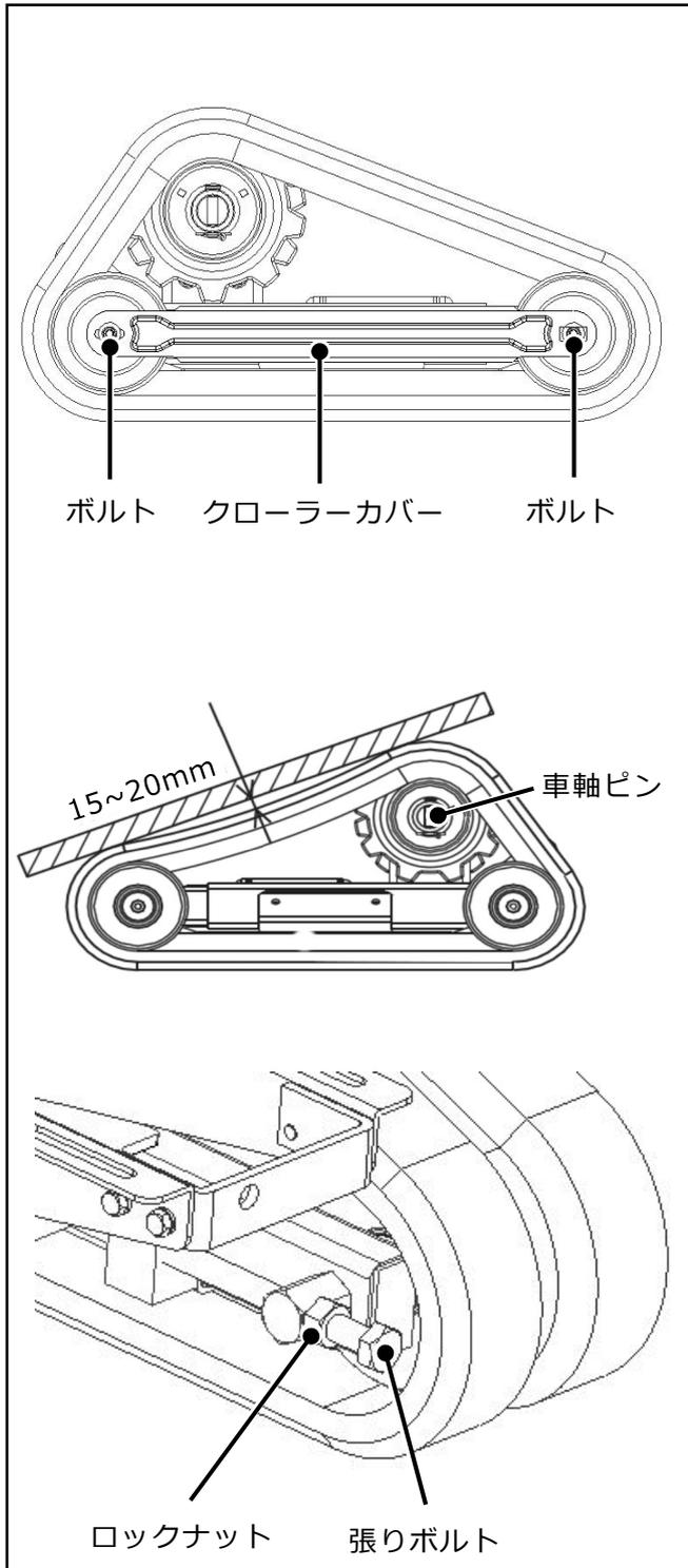
クローラーの張りが正しく調整されていないと脱輪したり、クローラーの寿命を著しく縮めますので以下の要領に従って、クローラーの張りを調整してください。
