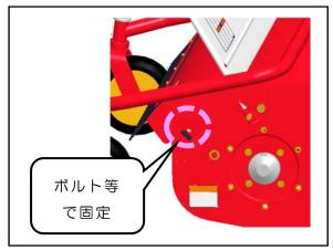
①フロントガードを上げ、ロータリーカバー横の穴と フロントガード横の穴との位置を合わせ、ボルト等 で固定するとフロントガードが開いたままとなり、 作業がしやすくなります。
