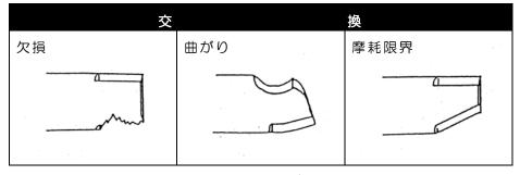
★ナイフの裏返し、交換の際には元の通りにしっかりとナイフ取付ボルトを締めつけて下さい。 Uナットをナイフブラケットとの遊びが無くなるまで締め込んで下さい。ナイフの動きがフリーで無くなった場合は、約1/4回転緩めて下さい。ナイフブラケットとボルト・Uナットに 遊びがなく、ナイフがフリーの状態になっている場合は正常に取付けられています。
