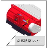
②作業状況に合わせて刈高調整レバーで刈高さを調整して下さい。
