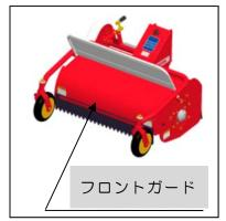
①草刈り作業をする時は、フロントガードは常に最下部へ下げた 状態で使用してください。飛散物が飛び出して危険です。
