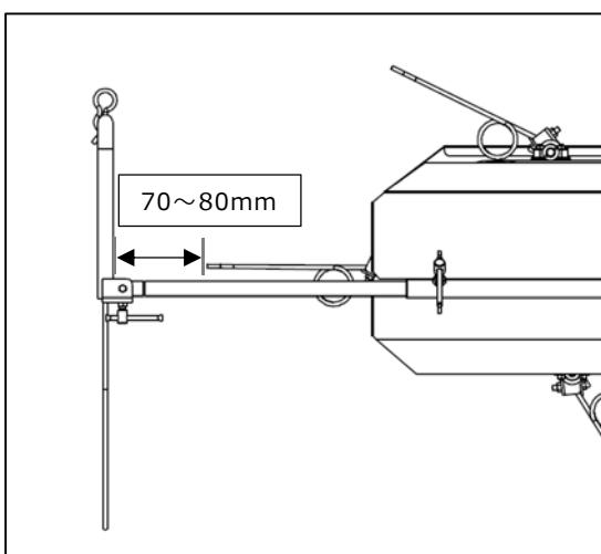
集草作業をする場合、草の丈が比較的低い場合にのみ、草が遠くに飛ばされない様にこのレーキに当てる下に落としていきます。長い草の場合は“付き回り”的原因にもなりますので集草レーキは取り外しておいてください。調整はレーキに取り付けられた集草フォークが地面と垂直になるように、またスプリングタイン先端との距離を 70~80mm 程度になるように 3箇所のジャッキボルトで調整し、調整後はしっかりとジャッキボルトを締め付けておいてください。拡散・反転作業時には、取り外しておいてください。
