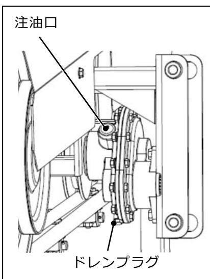
ギヤケース上部の注油口よりミッションオイル(#90)を50cc油差しに入れて注油してください。
