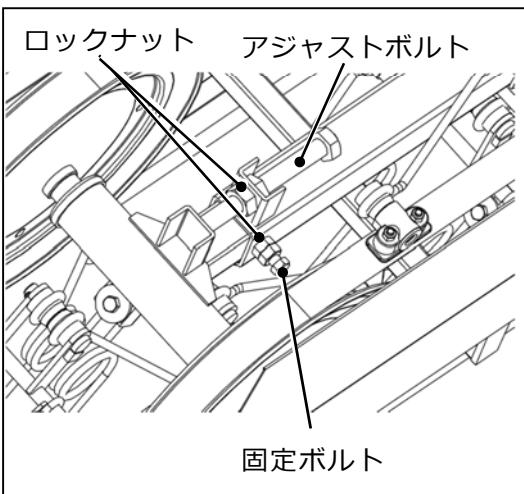
① タインフレーム付け根にある固定ボルトを緩めてください。
