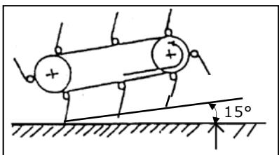
作業に応じてタインフレームの対地角度を作業方向に最大で 15° まで傾けることができます。
