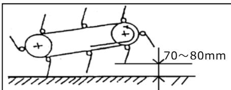
① 作業位置より見て、右端部でタイン先端と地面との間隔が 70~80mm 程度になるようにタインフレームアジャスターで調整します。
