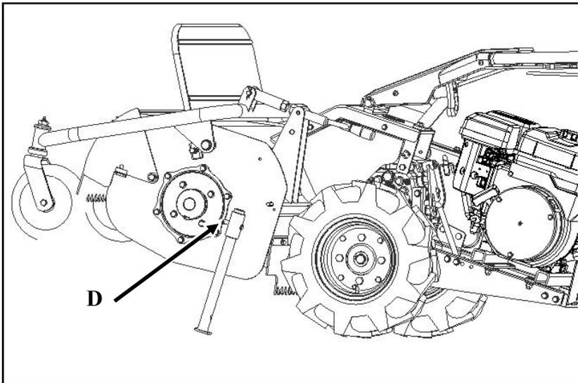
④ Dの位置でピンを差込み、ロータリーカバーを持ち上げた状態で固定します。
