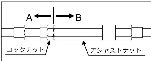
各ワイヤの調整は左図を参考にアジャストナットでワイヤの張りを調整してください。
