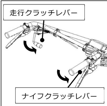
⑦ 作業を停止する場合は、まず走行クラッチレバーを「切」位置にし、本機を停止させます。同時に駐車ブレーキが掛かります。
