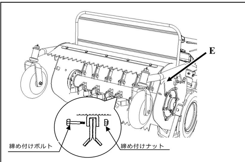
⑤ フロントカバーを開け、落ちてこないように②で取外したピン等を使用して固定してください（E）。
