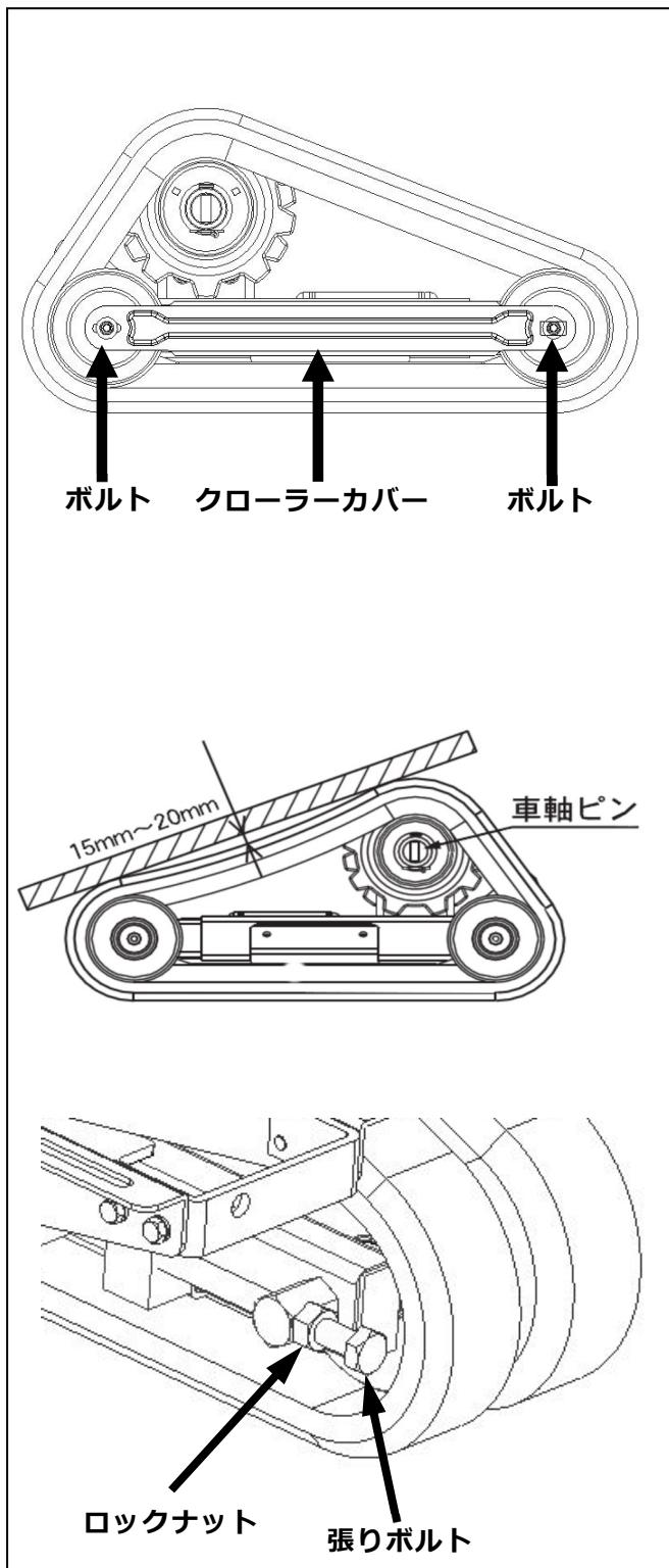
クローラーの張りが正しく調整されていないと脱輪やクローラーの寿命を著しく縮めますので以下の要領に従って、クローラーの張りを調整してください。
