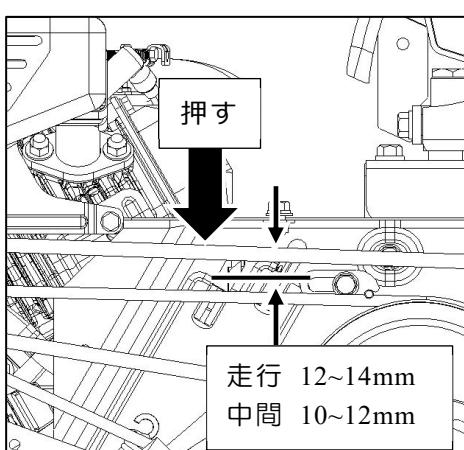
ベルトの交換を行った場合には、左図を参考にベルトの張りの調整をしてください。
