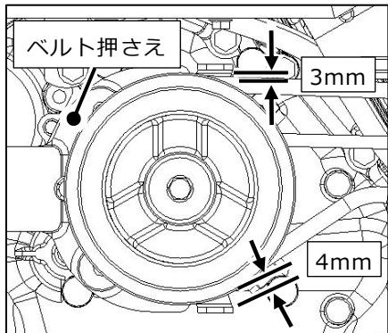
ベルトの交換を行った場合には、左図を参考にベルト押さえの調整をしてください。
