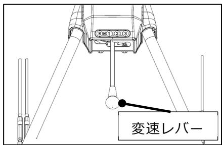
② 変速レバーを操作し、所要の変速位置に確実に変速してください。
