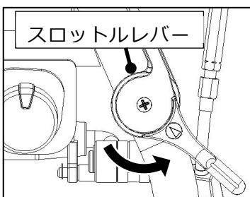
① スロットルレバーを低速「」位置にし、エンジンスイッチを押して「停止(OFF)」位置にしてエンジンを停止してください。
