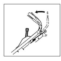
③走行クラッチレバーを前へ倒して、タイヤを回転させ吸い 込み(清掃)作業を行います。
