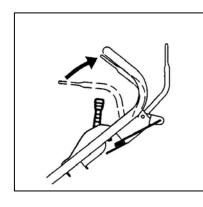
②ファンクラッチレバーを手元へ倒して、ファンを回転させます。
