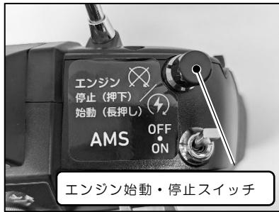
② プロポのエンジン始動・停止スイッチを押して、エンジンを停止させてください。
