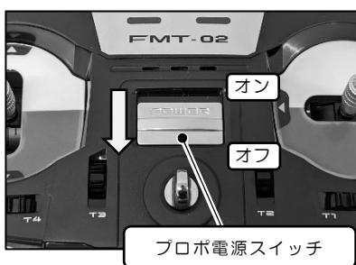
④ プロポの電源を「オフ」位置にしてプロポの電源を切ってください。
