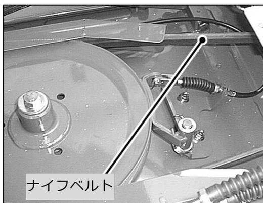
ベルトに損傷がないか目視点検してください。ヒビ、
