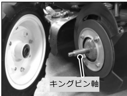
タイヤホイール内側を清掃してください。組付ける際はキングピン軸にグリスアップ、注油してください。
