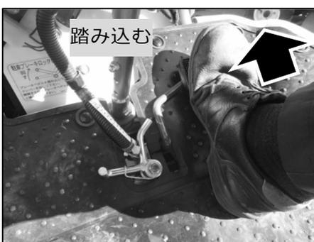
① クラッチブレーキペダルを踏み込み、本機を停止してください。
