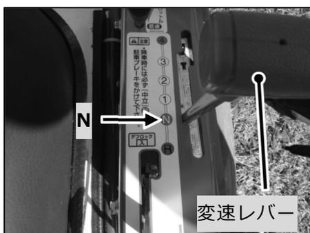
平坦地では、変速レバーを「N」位置にするとエンジンをかけずに空押ししやすくなります。エンジントラブル時等に使用します。
