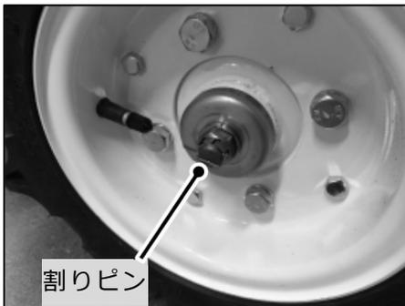
ホイールキャップ、割りピン、ナットを外し、タイヤを取り外してください。点検、清掃を行った後に組付ける際は、割りピンは再利用せず、新品を使用してください。ナットは割りピンを通す穴位置を合わせて締付けてください。
