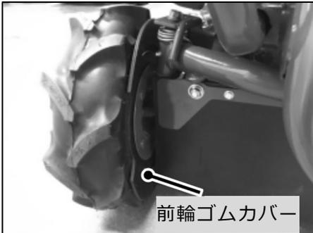
前輪ゴムカバーで刈った草の巻き上げ、ゴミの進入などを抑えています。定期的に前輪を外し、点検、清掃を行ってください。
