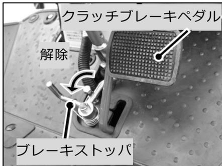
④ クラッチブレーキペダルを深く踏み込みブレーキストッパを解除してください。
