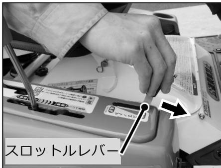
③ スロットルレバーを「高速」側へ倒し、エンジンの回転を上げて下さい。
