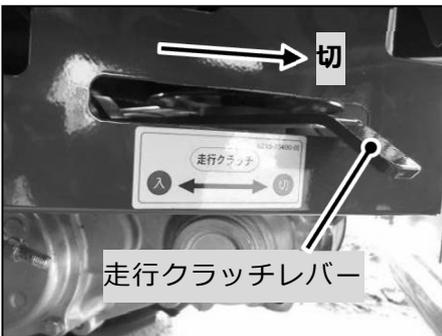
平坦地では、走行クラッチを「切」位置にするとエンジンをかけずに空押ししやすくなります。エンジントラブル時等に使用します。
