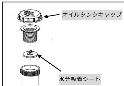
HST オイルタンク内のオイル量を外観から点検し、オイルのレベルが上限と下限との間にない場合には、オイルタンクのキャップを開け、HST オイルを上限まで補給して下さい。
