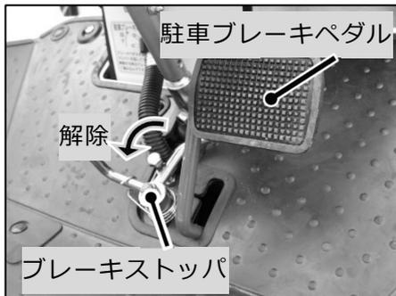
④ 駐車ブレーキペダルを深く踏み込みブレーキストッパを解除して下さい。
