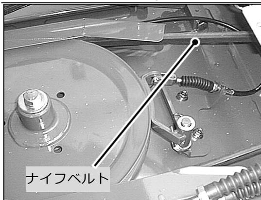
ベルトに損傷がないか目視点検してください。
