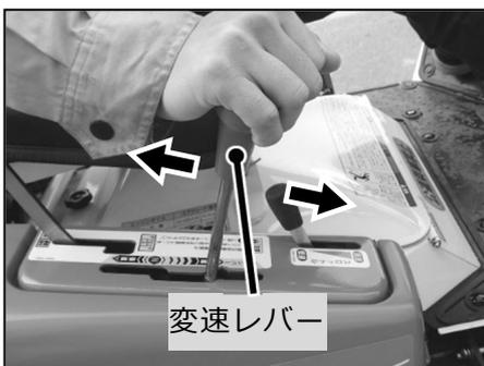
⑤ 変速レバー(チェンジペダル)をゆっくりと前方に倒して(踏み込んで)、本機を前進させてください。
