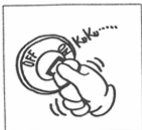
本機への取り付けが完了したらエンジンを始動して下さい。尚、始動操作は5秒以内とし、1回で始動しない場合は10秒以上休止後、再び始動操作を行って下さい。但し、この操作を行っても始動しない場合は、バッテリーの寿命も考えられますので、バッテリーや始動回路等を調べて下さい。
