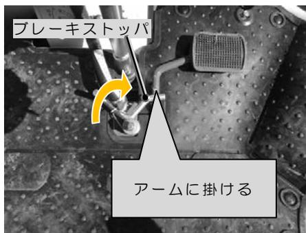
②クラッチブレーキペダルを踏み込み、本機を停止させて下さい。この際、変速レバーは前進「①」又は後進「R」位置に入れておいて下さい。
