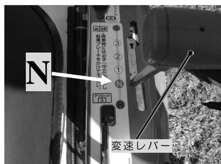
・平坦地では、クラッチブレーキペダルを踏み込まず、変速レバーを「N」位置にするとエンジンをかけずに空押できます。エンジントラブル時等に使用します。
