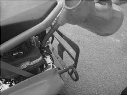
③まず**1リットル**のオイルを給油し、約**30秒間**低速で運転して下さい。エンジンを一旦停止し約**30秒間**待ってレベルゲージの上限位置までゆっくりとオイルを補給して下さい。〈エンジンオイル量は34頁《仕様》参照〉
