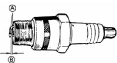
**△危険** 点火プラグの発火テストは、シリンダーのプラグ穴付近で行わないで下さい。引火して危険です。
