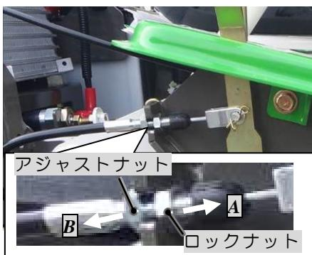
左写真を参考に、デフロックワイヤのアジャストナットで調整し、調整後は確実に作動するか確認して下さい。
