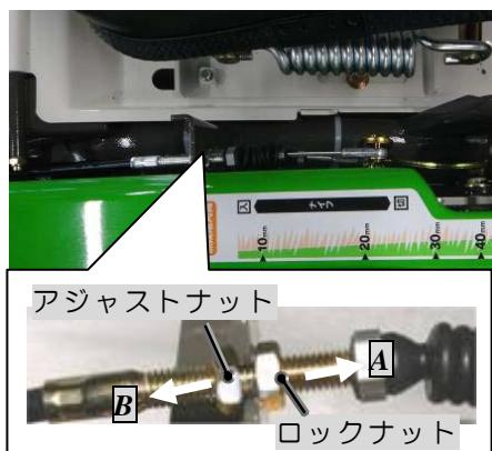
左写真を参考に、ナイフクラッチワイヤのアジャストナットで調整して下さい。
