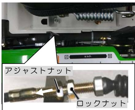
① ナイフはナイフクラッチレバーを「切」位置にすると約5秒内で停止します。停止しない場合は、ブレーキワイヤのアジャストナットを矢印方向に移動して調整して下さい。(ブレーキの引きずりは本製品故障の原因となります。)調整後はロックナットで確実に固定して下さい。
