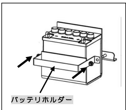
(1) バッテリ取付台に異物がない事を確認し、取り外したバッテリの端子極性が同じ位置になるように取り付け台に載せ、バッテリホルダーでガタツキがないようにしっかりと固定して下さい。
