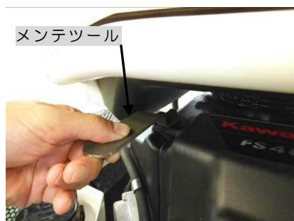
**△危険** エアクリーナ・ファンカバーが草屑等で目詰まりを起こしたまま作業を続けると、出力不足や燃料消費が多くなるばかりでなく、排ガス温度が上昇して燃料への引火火災の原因となり大変危険です。必ず定期的な清掃を励行して下さい。
