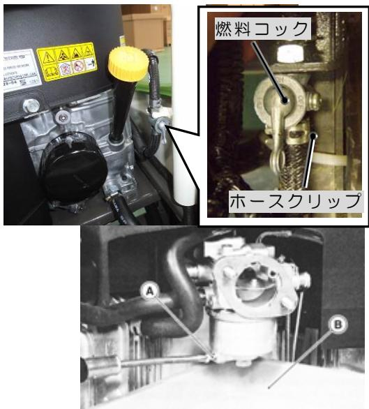
① 本機を30日以上使用しない時には、燃料変質による始動不良又は運転不調にならないよう、まず燃料タンク内の燃料をポンプ等で給油口から容器に抜き取り、残りの燃料を燃料コックのタンク側の燃料ホースクリップを前方にずらして外し、残留燃料を容器Bに受けて下さい。次にドレンボルトAをドライバで弛め、気化器内の燃料を容器Bに排出し、全ての燃料を指定の容器に移して湿気のない場所を選んで保管して下さい。
