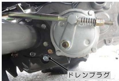
交換は、オイルを受け取る適当な容器を用意し、初回は**20時間**目、それ以降は**100時間**を目安にミッションケース左側面下部のドレンプラグ(排油栓)を外して下さい。
