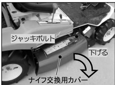
①本製品右側のナイフ交換用カバーは一番下まで下げ、作業中開く事の無い様ジャッキボルトでしっかりと締付けておいて下さい。
