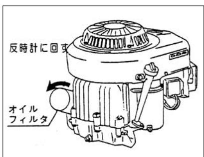
①フィルタAを反時計方向に回して取り外して下さい。
