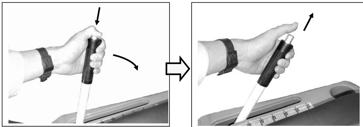
※ナイフ回転時と停止時とではナイフ高さは異なります。(高速回転による遠心力でナイフが多少浮き上がる為です。)目盛はナイフ回転時(試験圃場内)の数値です。実際の草刈作業時目安刈高としてご参考下さい。(圃場により若干異なります)
