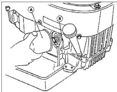
④給油口から新しい規定のオイルを給油して下さい。
