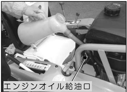
③まず1リットルのオイルを給油し、約30秒間低速で運転して下さい。エンジンを一旦停止し約30秒間待ってレベルゲージの「FULL」位置までゆっくりとオイルを補給して下さい。
