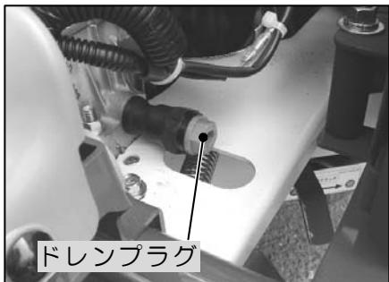
①オイルを受け取る適当な容器を用意し、給油栓を緩めた後エンジン左後部のドレンプラグ(排油栓)をM19の工具(スパナ等)を使って外して下さい。(給油栓を緩めて大気圧をかけるとスムーズにオイルが排出できます)
