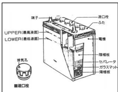
毎日の始業点検で電解液高さを確認して下さい。使用しない場合でも1ヶ月に1度は電解液高さを点検して下さい。液面がUPPER(高液面) LOWER(最低液面)間の半分以下に下がっていれば精製水(蒸留水)をUPPERレベルまで補充して下さい。
