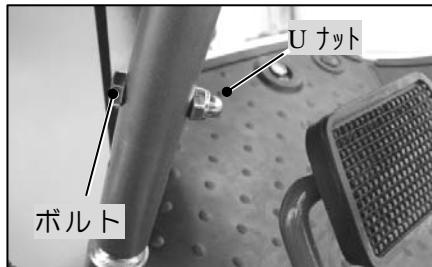
ハンドルシャフトを固定しているボルトとUナットで調整して下さい。
