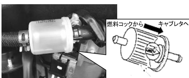
インライン燃料フィルタはシーズン毎もしくは必用に応じて早めに換して下さい。これの分解・清掃はできません。交換時には挿入方向に注意して下さい。
