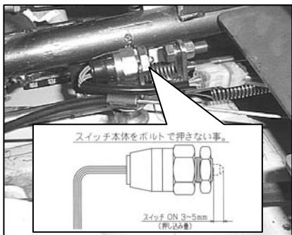
シートに座り、刈高調整レバーは「移動」位置に、駐車ブレーキペダルはロックして(踏み込んで)いるにも関わらず、エンジンが始動しない場合には下記要領で安全スイッチの調整を行って下さい。スイッチ先端が3.0~5.0mmの範囲で押し込まれたときに作動するようになっています。この範囲以外でスイッチ先端が押し込まれた場合にはエンジンが始まらない。特に押し込みすぎた場合にはスイッチ本体が損傷する恐れがありますので、左図を参考に安全スイッチの調整を行って下さい。
