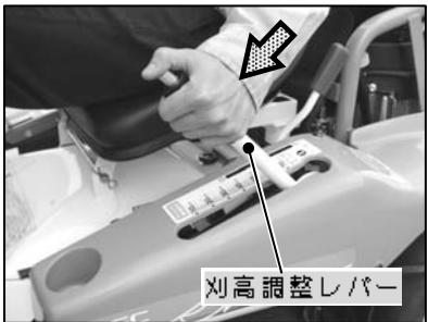
④まず、刈高調整レバーを 60 mm 程度の刈高さ位置に調整して下さい。<刈高さの調整方法は 8 頁…各部のはたらき参照>
