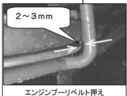
③各ベルト押えとの隙間を下記を参考に調整して下さい。
