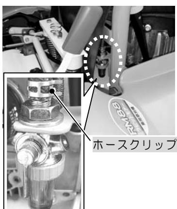
①本機を30日以上使用しないときには、燃料変質による始動不良又は運転不調にならないよう、まず燃料タンク内の燃料をポンプ等で給油口から容器に抜き取り、残りの燃料を燃料コックのタンク側の燃料ホースクリップを前方にずらして外し、残留燃料を容器Bに受けて下さい。次にドレンボルトAをドライバで弛め、気化器内の燃料を容器Bに排出し、全ての燃料を指定の容器に移して湿気のない場所を選んで保管して下さい。
