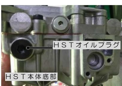
HSTオイルは、最初は清浄であっても長時間運転するうちにユニット内へのスラッジ等の沈殿及びオイルの劣化等が進行し、HSTの円滑な作動に支障をきたすようになります。
