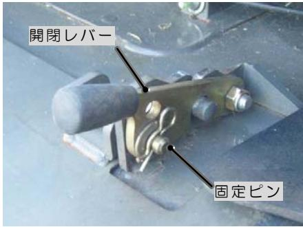
①本製品右側のナイフ交換用カバーは、作業中脱落する事の無い様、開閉レバーを固定ピンでしっかりと固定して下さい。
