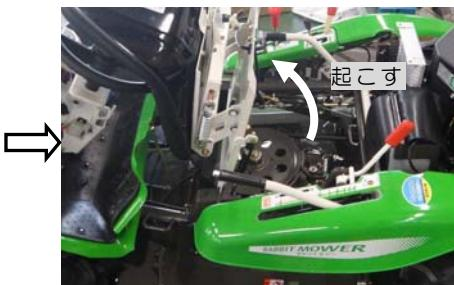
ベルト及びナイフブレーキの調整は、矢印部に手を掛け上部へ引き上げるようにシートブラケットを開け、シートを立てた状態で行って下さい。(持ち上げればその位置で固定します。)
