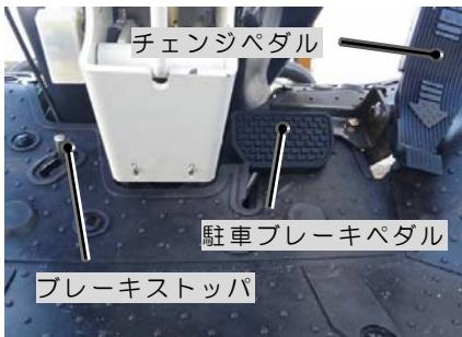
⑤駐車ブレーキペダルを踏み込んでブレーキストッパーを掛けて下さい。チェンジペダル又は変速レバーが中立「N」位置以外にある場合は中立「N」位置まで戻して下さい。
