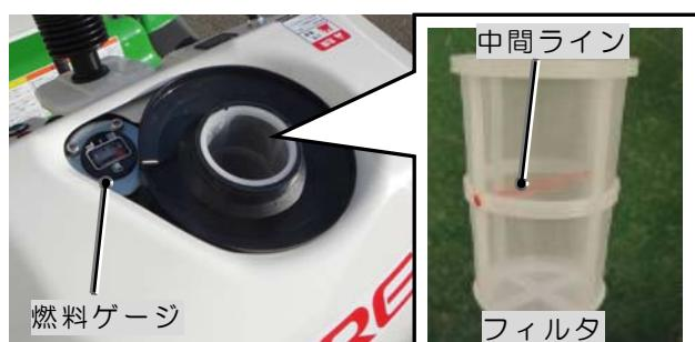
②燃料を確認して下さい。(燃料タンク全容量は14㍑です。)燃料は無鉛レギュラーガソリンを入れて下さい。メーターパネル上の燃料ゲージが「E」位置に近づいたら早めに燃料を補給して下さい。
