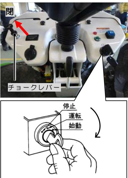
⑨エンジンスイッチにキースイッチを差し込み「運転」位置から続けて「始動」位置へキースイッチを回すとエンジンが始動します。
