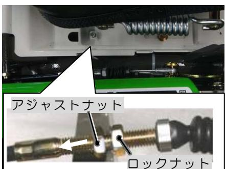
①ナイフはナイフクラッチレバーを「切」位置にすると約5秒内で停止します。停止しない場合は、ブレーキワイヤのアジャストナットを矢印方向に移動して調整して下さい。(ブレーキの引きずりは本製品故障の原因となります。)調整後はロックナットで確実に固定して下さい。
