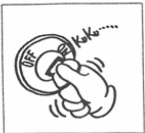
本機への取り付けが完了したらエンジンを始動して下さい。尚、始動操作は5秒以内とし、1回で始動しない場合は10秒以上休止後、再び始動操作を行って下さい。但し、この操作を行なっても始動しない場合は、バッテリの寿命も考えられますので、バッテリや始動回路等を調べて下さい。
