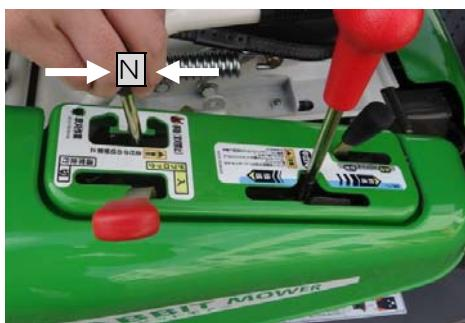
平坦地では、副变速レバーを「中立」N位置にするとエンジンをかけずに空押が出来ます。エンジントラブル時等に使用します。
