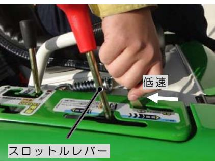
**参考 :** 暖機運転を行うことにより、エンジン各部にオイルを行き渡らせ、エンジンの寿命を延ばします。
