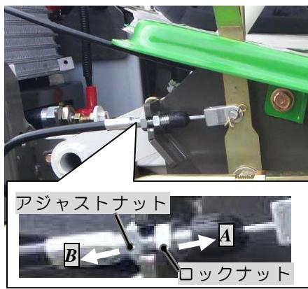
左写真を参考に、デフロックワイヤのアジャストナットで調整し、調整後は確実に作動するか確認して下さい。
