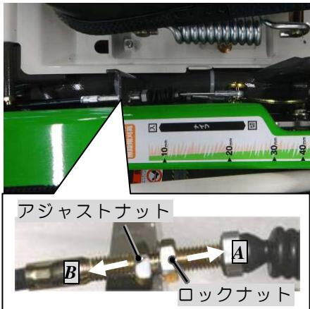
左写真を参考に、ナイフクラッチワイヤのアジャストナットで調整して下さい。
