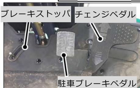
③ 駐車ブレーキペダルを踏み込んでブレーキストップを掛けてください。エンジンペダルまたは変速レバーが中立「N」位置以外にある場合は、中立「N」位置まで戻してください。
