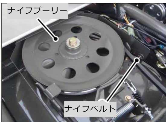
ベルトに損傷がないか目視点検してください。ヒビ、摩耗等の損傷があれば新品と交換してください。
