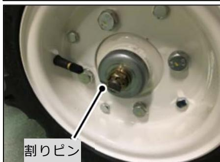
① ホイルキャップ、割りピン、ナットを取り外してください。点検、清掃を行った後に組付ける際は、割りピンは再利用せず、新品を使用してください。ナットは割りピンを通す穴位置を合わせて締付けてください。
