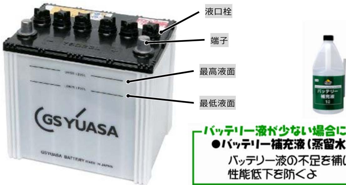
毎日の始業点検で電解液高さを確認してください。使用しない場合でも 1 ケ月に 1 度は電解液高さを点検してください。液面が、UPPER(最高液面)とLOWER(最低液面)間の半分以下に下がっていれば、精製水(蒸留水)をUPPERレベルまで補充してください。
