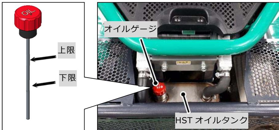
HST オイルタンク内のオイル量をオイルゲージで点検し、レベルゲージの上限と下限との間がない場合には、オイルタンクのキャップを開け、上限まで HST オイルを補給してください。
