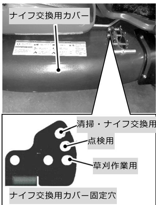
ナイフの点検・交換時用に、3箇所の固定位置があります。下から「草刈作業用」「点検用」「ナイフ交換用」となっています。それぞれの用途に合わせて、固定して作業することができます。
