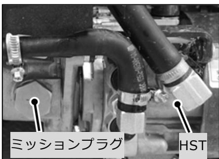
点検は、ミッションケース後部のミッションプラグを外して確認してください。注油口を通してミッションオイルが目視で確認できれば(注油口下側のふちまで)ほぼ規定量のミッションオイルが入っています。注油口が検油口を兼ねています
