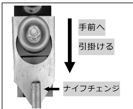
① まずナイフチェンジをナイフステー及びナイフの上から被せるようにして掛け、ナイフを確実に固定してください。この時、左図のようにナイフチェンジを手前に引きナットガードに引掛けください。
