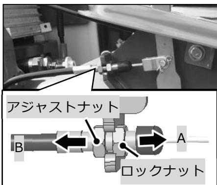
① 左写真を参考に、デフロックワイヤのロックナットを緩め、アジャストナットで調整し、調整後は確実に作動するか確認してください。
