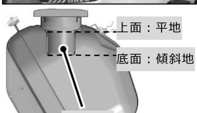
③ フロントマスクの上端（矢印部）に手をかけて、フロントマスクを開閉してください。燃料はフィルタの上面以上は入れないでください。路面の凹凸、斜面での燃料漏れの原因となります。こぼれた燃料はきれいに拭き取ってください。
