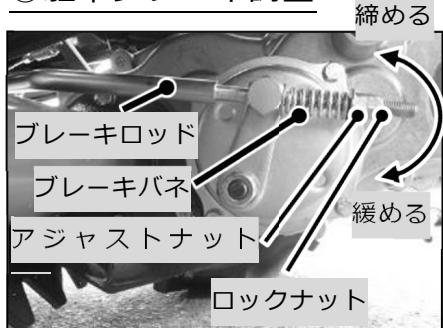
① 駐車ブレーキは、ミッションの左側後部にあり、これに接続されているブレーキロッド後部のアジャストナットで調整します。調整は駐車ブレーキペダルを一杯に踏み込んだ時（ペダルをブレーキストップでロックした時）、後輪が「ロック」するようにロックナットを緩め、アジャストナットを調整します。アジャストナットを右に回して締め込んでいくと早く効き始め、反対に緩めると遅く効きます。
