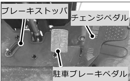
③ 駐車ブレーキペダルを踏み込んでブレーキストッパーを掛けてください。チェンジペダルまたは変速レバーが中立「N」位置以外にある場合は、中立「N」位置まで戻してください
