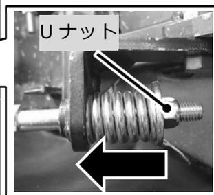
オフセット部全体の傾きは左図の U ナットにて調整できます。経年劣化等でオフセット部全体が下がってきた場合に調整してください。
