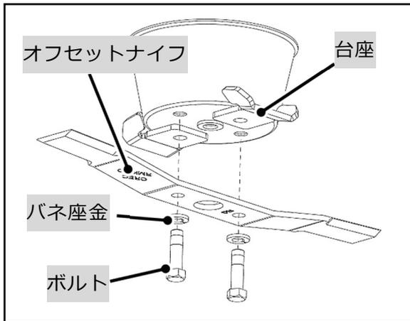
① 左図 2 枚を参考に、ロータリー皿の穴からボックスレンチ、オフセットナイフ交換工具を使用して、バーナイフを固定しているボルト 4 本を外します。
