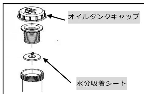
HST オイルタンク内のオイル量を外観から点検し、オイルのレベルが上限と下限との間にない場合には、オイルタンクのキャップを開け、HST オイルを上限まで補給して下さい。
