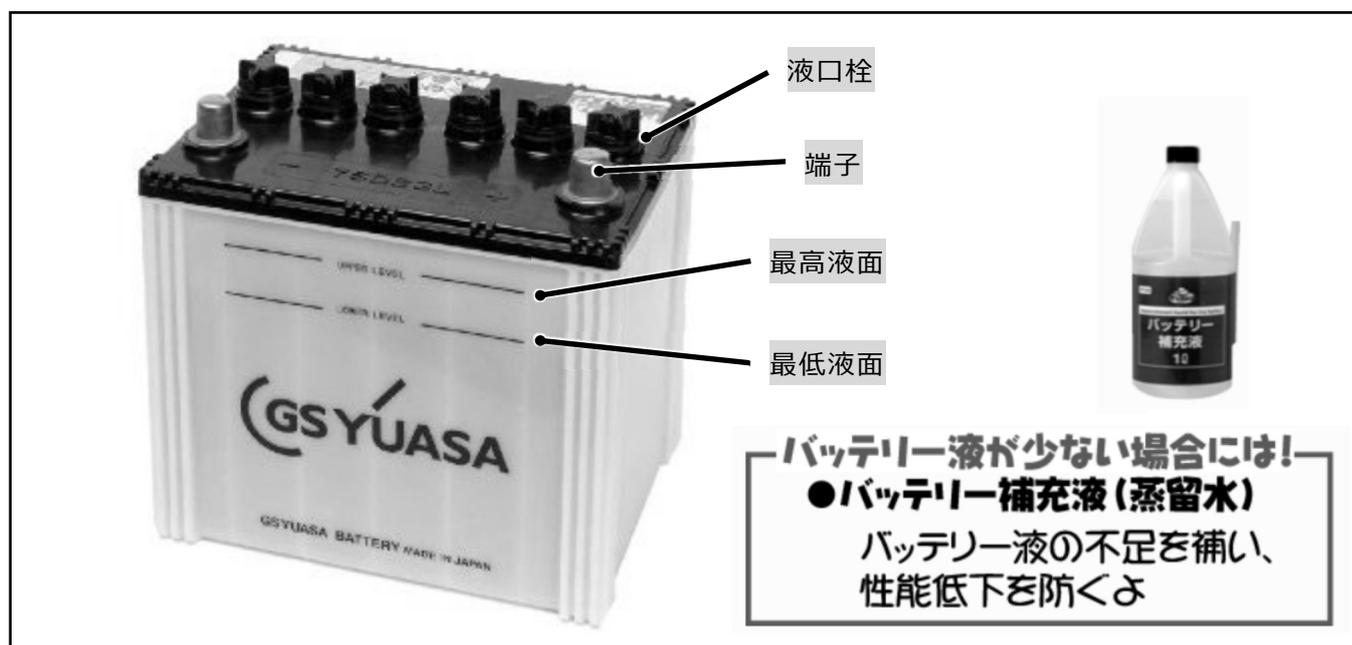
毎日の始業点検で電解液高さを確認してください。使用しない場合でも1ヶ月に1度は電解液高さを点検してください。液面がUPPER(最高液面)とLOWER(最低液面)間の半分以下に下がっていれば精製水(蒸留水)をUPPERレベルまで補充してください。
