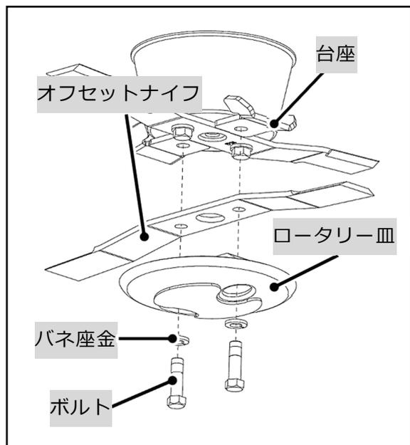
③ 左図を参考に、オフセットナイフを下向きで、ロータリー皿と共にボルトで固定します。この際、ネックガードの台座が付いている穴に取り付けてください。(締付トルク 54N・m)
