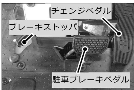
③ 駐車ブレーキペダルを踏み込んでブレーキストッパを掛けてください。チェンジペダルまたは変速レバーが中立「N」位置以外にある場合は中立「N」位置まで戻してください
