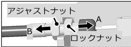
① 左写真を参考に、デフロックワイヤのロックナットを緩め、アジャストナットで調整し、調整後は確実に作動するか確認してください。
