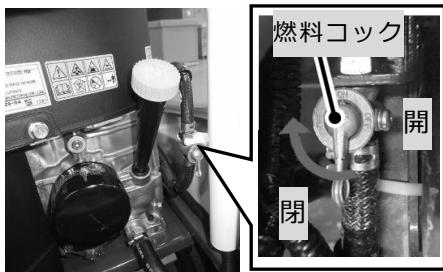
① 本機を**30日以上**使用しない時には、燃料変質による始動不良または運転不調にならないよう、まず燃料タンク内の燃料をポンプ等で給油口から容器に抜き取り、残りの燃料を、エンジンを始動させ、「ガス欠状態」となり、停止するまでエンジンを回します。
