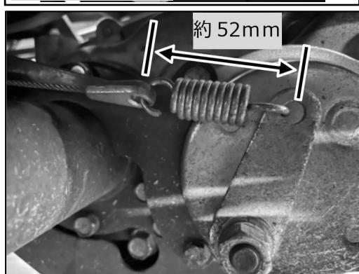
③ ブレーキバネがブレーキペダル解除時に約52mm、ペダルロック時に約60mmになるように調整し、(過度な引っ張りはブレーキの引きずりの原因となります。)調整後はロックナットで確実に固定してください。
