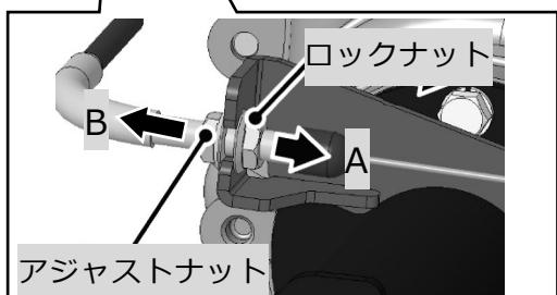
② 調整は駐車ブレーキペダルを一杯に踏み込んだ時(ペダルをブレーキトップでロックした時)、後輪が「ロック」するようにブレーキワイヤー部のアジャストナットで調整します。ロックナットを緩めてアジャストナットをA方向に調整していくとワイヤーが張られ、ブレーキが早く効き始め、B方向に調整していくとワイヤーの張りが緩み遅く効きます。
