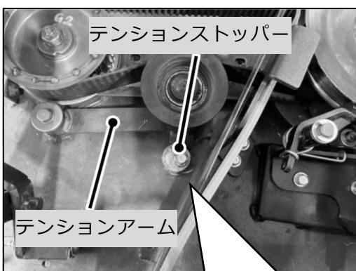
④ テンションストッパーを矢印方向に動かし、テンションアームに当てて確実に固定してください。
