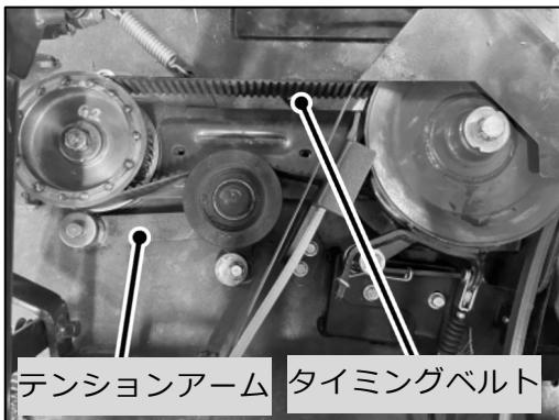
① ベルトに損傷がないか目視点検してください。ヒビ、摩耗等の損傷が あれば新品と交換してください。
