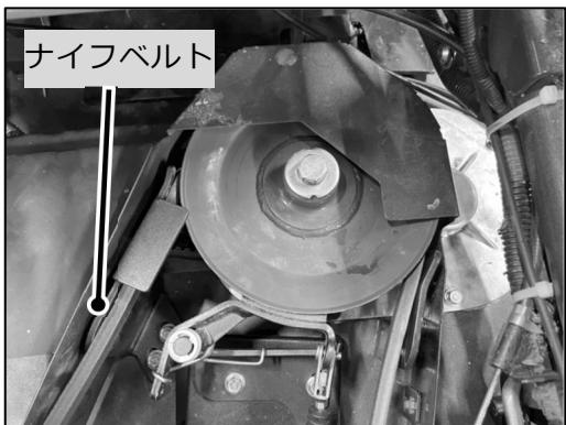
ベルトに損傷がないか目視点検してください。
