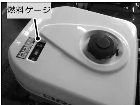
① 本機を水平にして燃料給油キャップを外し、給油口から燃料の量を点検します。
