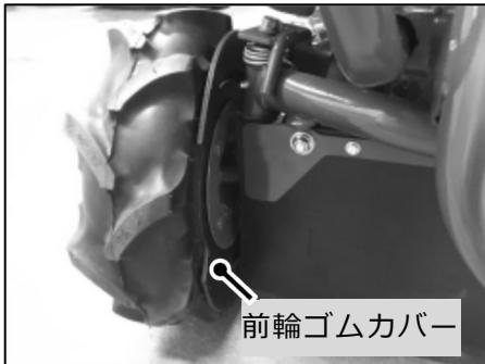
前輪ゴムカバーで刈った草の巻き上げ、ゴミの進入などを抑えていますが、定期的に前輪を外し、点検、清掃を行ってください。
