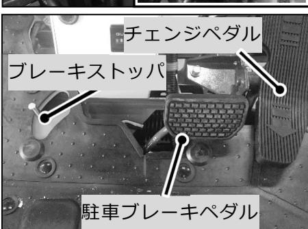
③ 駐車ブレーキペダルを踏み込んでブレーキストッパーをかけてください。エンジンペダルまたは変速レバーが中立「N」位置以外にある場合は中立「N」位置まで戻してください。
