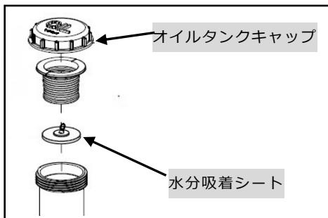
HST オイルタンク内のオイル量を外観から点検し、オイルのレベルが上限と下限との間にない場合には、オイルタンクキャップを開け、HST オイルを上限まで補給してください。
