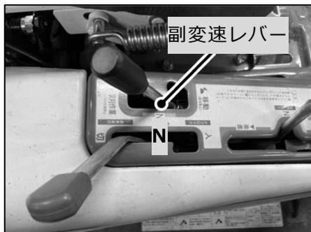
平坦地では、副变速レバーを中立「N」位置にするとエンジンをかけずに空押ししやすくなります。エンジントラブル時等に使用します。
