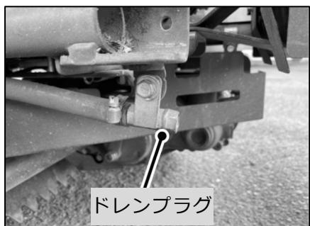
※ 初回は**5時間目**、それ以降は**50時間**(オイルフィルタ付)運転毎、もしくはシーズン毎のいずれか早い時期を目安に交換してください。但し負荷の厳しい作業条件や高温環境下での連続作業では、上記時間に達する前、早めのエンジンオイル(約**25時間**)及びオイルフィルタ(約**50時間**)の交換をお奨めします。
