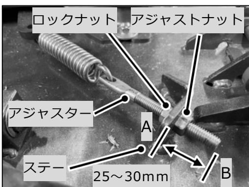
③ ロックナットを緩めてアジャストナットを A 方向に調整するとベルトの張りが強くなり、B 方向に調整するとベルトの張りが弱くなります。目安はアジャスターのネジ部分がステーから 25~30mm の範囲になるように固定してください。調整後はロックナットを確実に固定してください。
