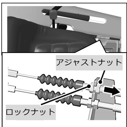
① ナイフはナイフクラッチレバーを「切」位置にすると約5秒内で停止します。停止しない場合は、ロックナットを緩め、ブレーキワイヤーのアジャストナットを矢印方向に調整してください。(ブレーキの引きずりは本製品故障の原因となります。) 調整後はロックナットで確実に固定してください。
