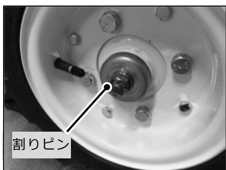
ホイルキャップ、割りピン、ナットを取り外して、タイヤを取り外してください。点検、清掃を行った後に組付ける際は、割りピンは再利用せず、新品を使用してください。ナットは割りピンを通す穴位置を合わせて締付けてください。
