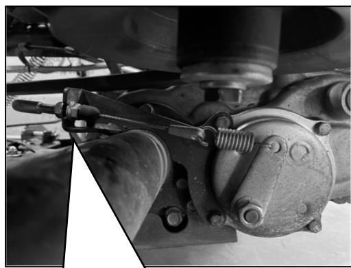
① 駐車ブレーキはミッションの左側後部にあり、これに接続されているブレーキワイヤー部のアジャストナットで調整します。
