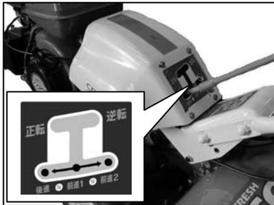
②変速レバーを操作し、所要の変速位置に確実に変速してください。
