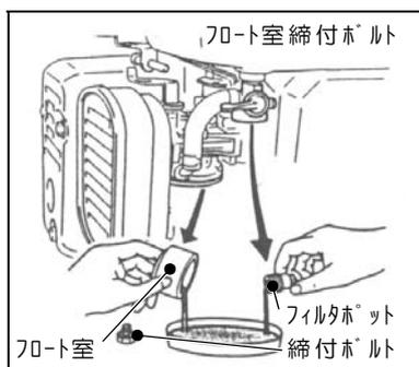
①本機を30日以上使用しないときは、燃料変質による始動不良、又は運転不調にならないように燃料タンク及び気化器内の燃料を抜き取って下さい。
