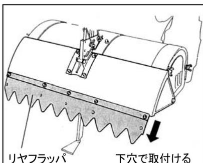
リヤフラップの取付け穴位置の上下を入れ替えることにより、より強いすじ目の入った平面耕に仕上がります。
