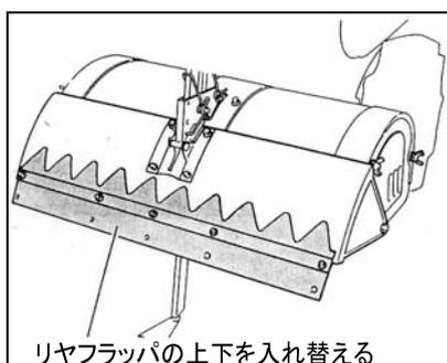
リヤフラップの上下を変えて取り付けると、すじ目の入らない平面耕に仕上がります。
