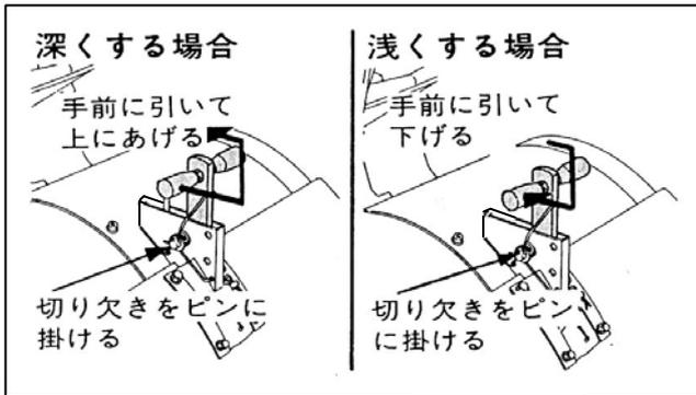
耕うん深さの調節は、耕深調節棒の上下によって行います。調節は6段階で可能です。耕深調節棒を手前に引き、“切欠き”から外して上下させ所要の位置で再び“切欠き”に噛み合わせて下さい。
