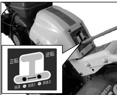
③ 変速レバーを「中立N」位置にし、主クラッチレバーから手を離して下さい。
