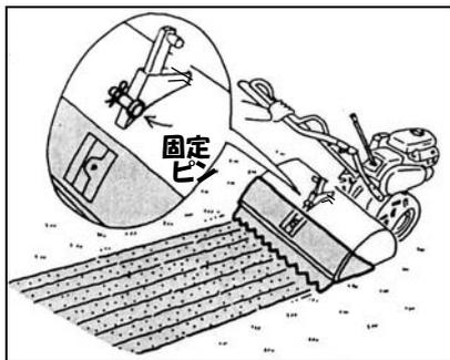
ロータリカバーの回転ロータリカバー固定ピンを外して作業をすることにより、均平度の高いすじ目の入った平面耕に仕上がります。
