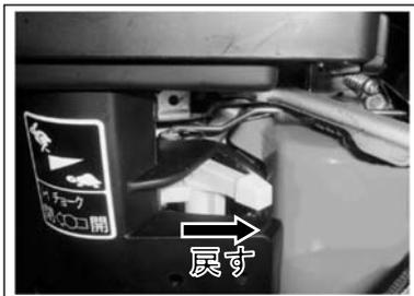
⑧エンジン始動後はチョークレバーを戻し、チョーク弁を「全開」
