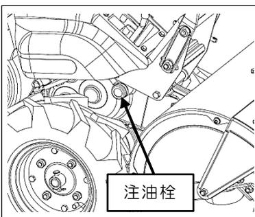
① ミッションケースの注油栓を取外してください。注油口からオイルが目視で確認できれば、ほぼ規定量のミッションオイルが入っています。
