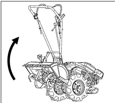
③ハンドルを持ち上げてロータリー部を浮かせ、主クラッチレバーを「入」位置に入れて旋回してください。
