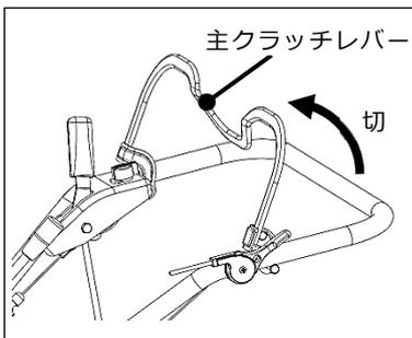
④作業を終了する場合には主クラッチレバーを「切」位置にし、変速レバーを「N」位置にしてください。その後、エンジンを停止してください。〈4.1.2 エンジン停止のしかた参照〉
