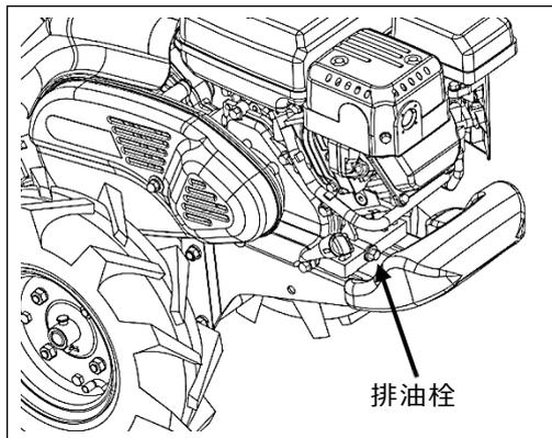
④ 排油を受ける容器を準備し、給油栓を外し、エンジン下部の排油栓(ドレンプラグ)を取り外し、容器にオイルを排出してください。
