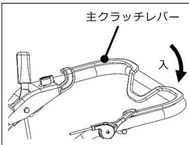
③スロットルレバーを「
