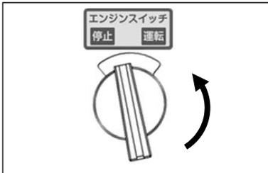
②エンジンスイッチを「**停止(OFF)**」位置に回し、エンジンを停止してください。
