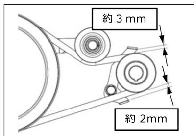
主クラッチレバーが「入」位置のとき、ベルトとベルト押えの間隔が上側で約 3 mm、下側で約 2 mm 程度になるようにベルト押さえの位置を調整してください。
