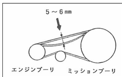
主クラッチレバーが「入」位置の時、ベルト中央部を軽く指で押してみても 5~6mm 程度のたわみがあれば正常です。
