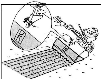
①ロータリーカバーの回動ロータリーカバー固定ピンを外して作業することにより、均平度の高いすじ目の入った平面耕に仕上がります。
