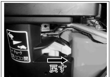
⑧エンジン始動後はチョークレバーを戻し、チョーク弁を「全開」位置にしてスロットルレバーを低速側「」位置でしばらく(5分程度)の暖機運転を行ってください。暖機運転を行うことにより、エンジンの寿命をのばします。
