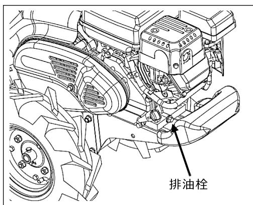
④排油を受ける容器を準備し、給油栓を外し、エンジン下部の排油栓(ドレンプラグ)を取り外し、容器にオイルを排出してください。
