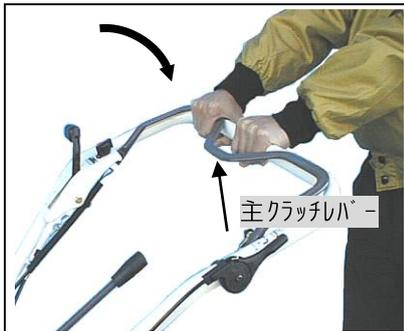
変速操作が不十分な場合、ギヤ抜けの恐れがあります。操作がやりにくい場合には、無理に入れずに主クラッチレバーを「入」方向へ少し動かしてから再度、操作を繰り返して下さい。
