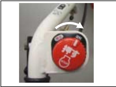
⑤エンジンスイッチを右に回し「運転」位置にして、上に引き上げて下さい。（確実にロックした事を確認して下さい）
