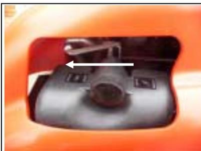
⑨エンジン始動後はチョークレバーを戻し、チョーク弁を「全開」
