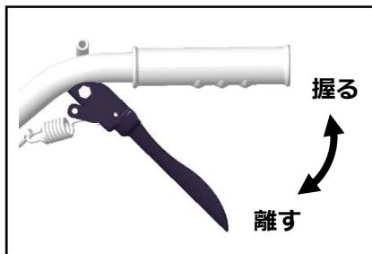
エンジンからミッションへの動力を断続させるデッドマン式クラッチレバーを採用しています。
