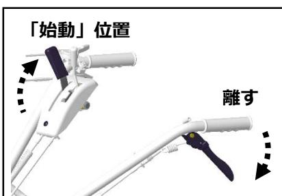
①走行クラッチレバーから手を離し、切換レバーを「始動」位置にして本機を停止してください。
