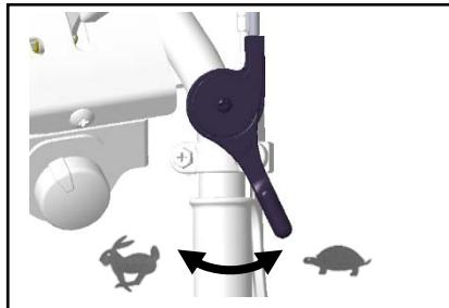
レバーを動かしてエンジン回転数の増減を調整します。走行速度の調整や雪を押す力を調整する為に使用します。
