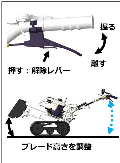
作業状況に合わせてブレードの高さを調整することができます。
