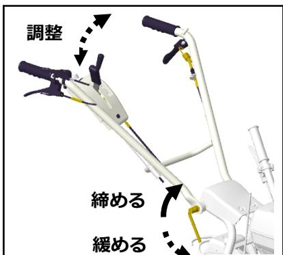
作業者の体格、及び作業状況に合わせてハンドル高さを約  $10^{\circ}$  の間隔で調節することができます。
