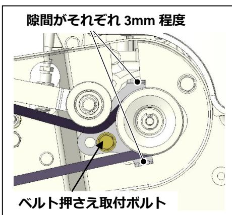
①切換レバーを作業位置にし、ベルトの下側中央部を指先で押してみて、4~6mm程度のたわみがあれば正常です。基準値以上にベルトがたわむ場合は、主クラッチワイヤを張ってください。
