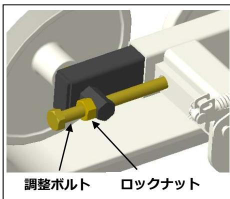
①車体前方の調整ボルトのロックナット（M12）を緩めてください。（左右とも）
