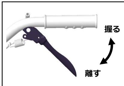
エンジンからミッションへの動力を断続させるデッドマン式クラッチレバーを採用しています。
