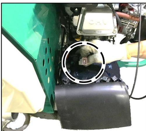
スローブローヒューズは過電流が流れたときにメインハーネスが損傷しないように保護するためのものです。
