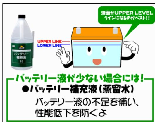
毎日の始業点検で電解液高さを確認してください。使用しない場合でも1ヶ月に1度は電解液高さを点検してください。液面がUPPER(高液面)LOWER(最低液面)間の半分以下に下がっていれば精製水(蒸留水)をUPPERレベルまで補充してください。
