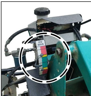
トラックへの積載やほ場の出入りをおこなう場合、傾斜計の針が傾き、参考程度に前後方向の角度が分かるようになっています。正確な角度はハンディタイプの角度計などで計測をしてください。15°以上の傾斜は危険ですので、15°以下で使用してください。
