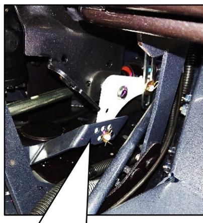
③ ブレーキロッドの取付け穴位置を変更し、駐車ブレーキをかけたときに車輪がロックするように調整してください。
