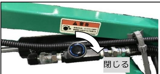
① 油圧シリンダー内の油圧作動油をオイルタンクへ戻すため、作業機を地面に接触しない程度まで下げ、油圧バルブを閉じてください。
