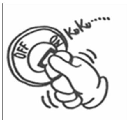
本機への取付けが完了したらエンジンを始動してください。尚、始動操作は 5 秒以内とし、1 回で始動しない場合は 10 秒以上休止後、再び始動操作をおこなってください。但し、この操作をおこなっても始動しない場合は、バッテリーの寿命も考えられますので、バッテリーや始動回路等を調べてください。
