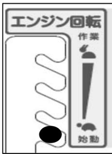
エンジン回転数の増減を調整します。「始動」位置でエンジンを始動し「作業」位置で作業を行ってください。
