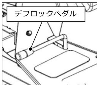
ぬかるみからの脱出、又はトラックへの積み降ろしや坂道の走行時に使用します。ペダルを踏むと4輪すべての差動がロックされます。
