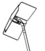
積載輸送時などにフロート部分のバタつき（上下動、回転）を抑えるため、フロートをロックするストッパーが 2 か所付いています。輸送時など、必要に応じてご活用ください。
