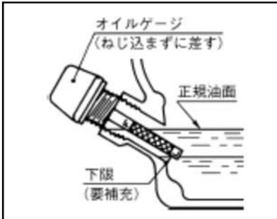
毎運転前に〈3.1 エンジンオイルの点検〉を参考にエンジンオイルの量、及び汚れを目視で点検し、規定量でない場合、及び汚れがひどい場合には、補給または全量交換（下記参照）してください。
