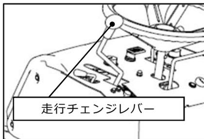
⑩ 走行チェンジレバーを前進側へ倒し、レーキを回転させてください。気泡が出て油面が下がりますので、都度注油してください。オイルが充填されるまでこの作業を繰り返してください
