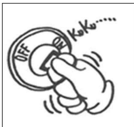
本機への取り付けが完了したらエンジンを始動してください。尚、始動操作は 5 秒以内とし、1 回で始動しない場合は 10 秒以上休止後、再び始動操作を行ってください。但し、この操作を行っても始動しない場合は、バッテリーの寿命も考えられますので、バッテリーや始動回路等を調べてください。
