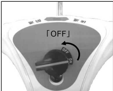
①主クラッチレバーから手を離し、エンジンスイッチを「停止(OFF)」位置にしてエンジンを停止してください。
