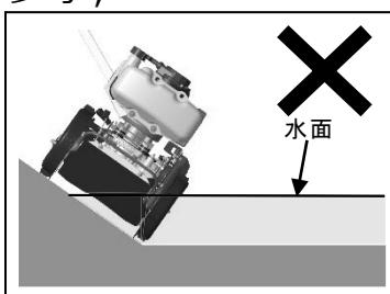
スパイク車輪(チェーンケース)は水につけないように作業してください。万が一、水につかるような作業をした場合、きれいに清掃した後じゅうぶんに乾燥させてください。泥水や、水分が付着したまま機体を放置すると、錆が生じ機体の早期破損につながる恐れがあります。
