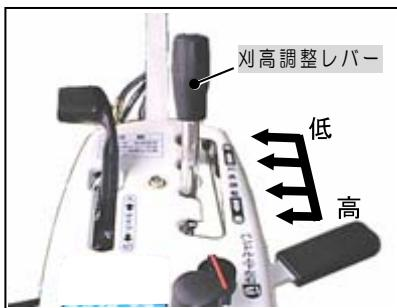
① 作業状況に合わせて刈高調整レバーで刈高さを調整して下さい。
