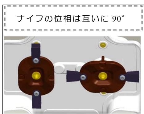
下図の様に異常な状態になっていたら、ナイフの左右を入れ替えて使用するか交換して下さい。
