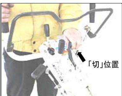
⑦作業を終了する場合には、まず主クラッチレバーから手を離し、本機を停止させて下さい。(遠心クラッチが切れ、ナイフの回転と走行が停止します。)
