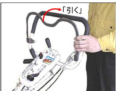
⑤主クラッチレバーを徐々にハンドル側に引いていくと、エンジン回転が上昇し、遠心クラッチによりナイフが回転を始めます。
