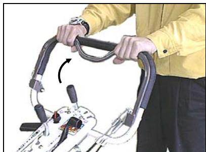
③主クラッチレバーを徐々にハンドル側に倒していくと、まずエンジン回転が上昇し、連動した走行クラッチの解除レバーが「入」位置となって走行を始めます。
