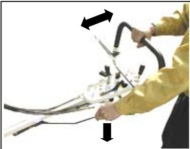
作業条件に合わせてハンドルの長さが 15 cm の間隔で 5 段階で固定できます。傾斜面の長さに応じて使い分けて下さい。
