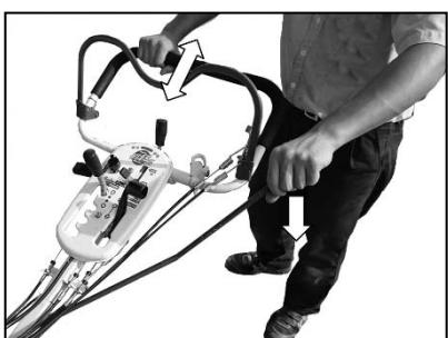
作業条件に合わせてハンドルの長さを15cmの間隔の5段階で固定できます。傾斜面の長さに応じて使い分けてください。
