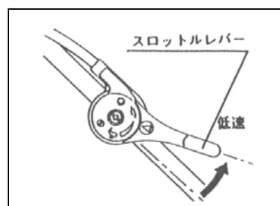
⑩スロットルレバーを低速「」位置にし、エンジンスイッチを「停止(OFF)」位置にしてエンジンを停止して下さい。
