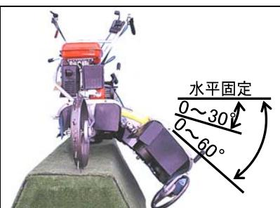
①畝の法面等での草刈作業には、作業状況に合わせてロックレバーで水平固定、 $0^\circ \sim 30^\circ$ 、 $0^\circ \sim 60^\circ$  自在の3段階に調整可能です。作業する法面の傾斜角度に応じて選択して下さい。自在から水平固定へはロックレバーの操作で戻せます。<操作のしかたは 7 頁各部のはたらき参照>
