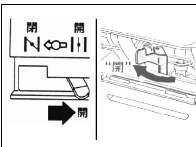
⑨エンジン始動後はチョークレバーを戻し、チョーク弁を「全開」位置にしてスロットルレバーを低速側「」位置でしばらく(5分程度)の暖機運転を行って下さい。
