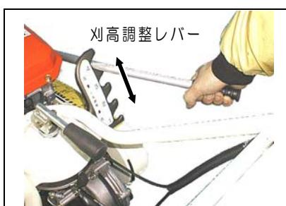
①作業状況に合わせて刈高調整レバーで調整して下さい。
