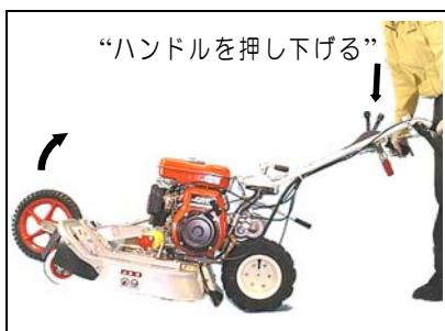
ハンドルを押し下げ、カッターユニット部分を地面から少し浮かせるようにして車輪接地部分のみで旋回するとその場で一点旋回ができます。
