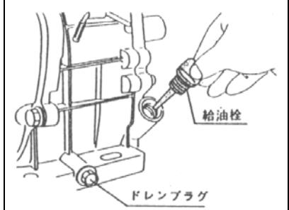
①毎日、もしくは8時間毎に〈10頁…エンジン始動のしかた〉を参考にエンジンオイルの量、及び汚れを目視で点検し、規定量でない場合、及び汚れがひどい場合には、補給又は全量交換（下記参照）して下さい。
