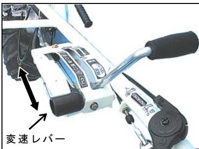
②変速レバーを操作し、所要の変速位置に確実に入れ替えて下さい。
