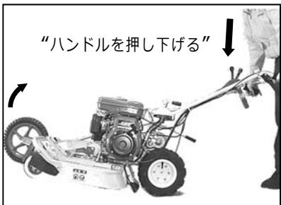
①ハンドルを押し下げ、カッターユニット部分を地面から少し浮かせるようにします。
