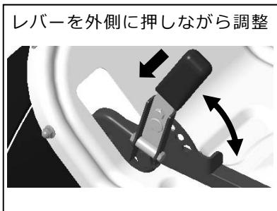
**参考** ; ガイド車輪は、レバーを外側へ押しながら上下に調整し、所要の位置で手を離すと「ロック」します。刈高調整レバーと同じ位置に調整するとほぼ水平となります。
