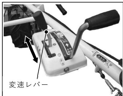
②変速レバーを操作し、「①」「②」「R」の必要な変速位置に確実に入れてください。
