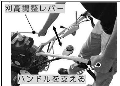
①作業状況に合わせて、刈高調整レバー・ガイド車輪レバーで刈高さを調整してください。
