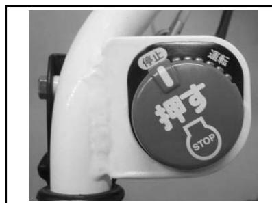
②エンジンスイッチを押して「停止(OFF)」位置にし、エンジンを停止してください。
