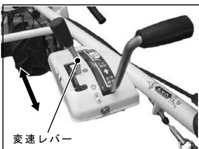
②変速レバーを操作し、所要の変速位置に確実に入れ替えてください。
