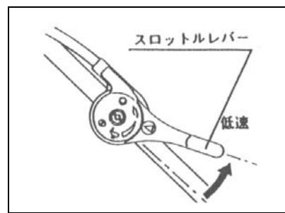
⑩スロットルレバーを低速「」位置にし、エンジンスイッチを「停止(OFF)」位置にしてエンジンを停止してください。
