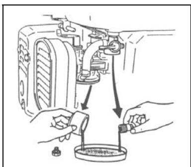
①本機を30日以上使用しないときは、燃料変質による始動不良、又は運転不調にならないように燃料タンク及び気化器内の燃料を抜き取ってください。
