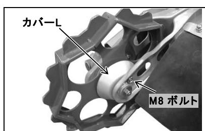
① 前輪の草巻き付き防止カバーLを取付けているM8ネジをスパナ等でゆるめて取り外します。
