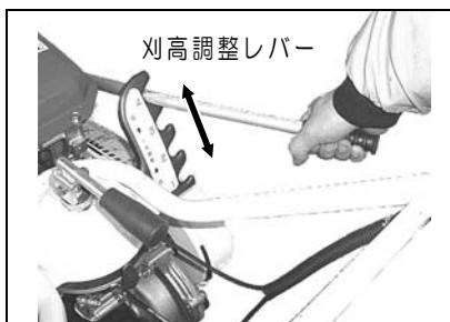
①作業状況に合わせて刈高調整レバーで調整してください。
