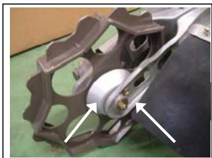
①前輪の草巻き付き防止カバー L を取付けているM8ネジをスパナ等でゆるめて取り外します。
