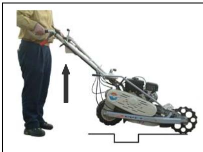
②前輪が溝を越えた後ハンドルを持ち上げタイヤ(後輪)を浮かせて走行クラッチレバーを握り前進します。
