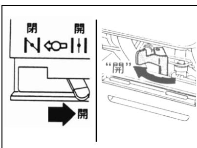
⑨エンジン始動後はチョークレバーを戻し、チョーク弁を「全開」位置にしてスロットルレバーを低速側「」位置でしばらく(5分程度)の暖機運転を行ってください。
