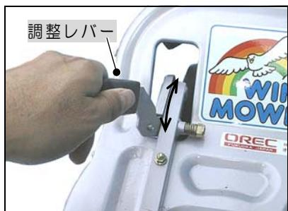
ガイド車輪は、調整レバーをエンジン側へ押しながら左右に調整し、所要の位置で手を離すと「ロック」します。刈高調整レバーと同じ位置に調整するとほぼ水平となります。
