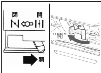
⑦エンジン始動後はチョークレバーを戻し、チョーク弁を「全開」位置にしてスロットルレバーを低速側「」位置でしばらく(5分程度)の暖機運転を行ってください。
