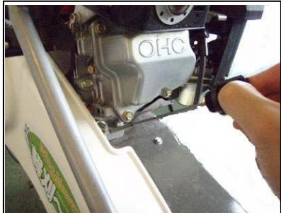
①毎運転前に〈3.1 エンジンオイルの点検〉を参考にエンジンオイルの量、及び汚れを目視で点検し、規定量でない場合、及び汚れがひどい場合には、補給または全量交換（下記参照）してください。
