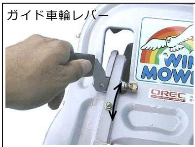
**参考** ; ガイド車輪は、レバーをエンジン側へ押しながら左右に調整し、所要の位置で手を離すと「ロック」します。
