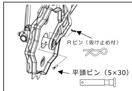
④新しい平頭ピン (5×30) を穴に入れて、Rピン (抜け止め付) を差してください。
