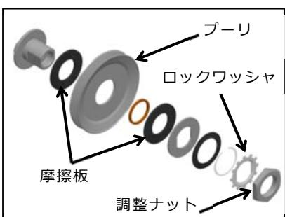
トルクリミッタブーリのトルクは使用することで変化していきます。リミッタの作動で本機が進みにくくなりましたら調整をしてください。
