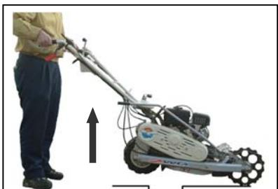
②前輪が溝を越えた後ハンドルを持ち上げタイヤ(後輪)を浮かせて走行クラッチレバーを握り、前進します。
