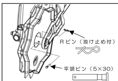
④新しい平頭ピン (5×30) を穴に入れて、Rピン (抜け止め付) を差してください。
