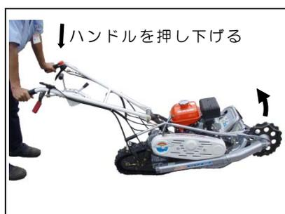
ハンドルを押し下げ、カッターユニット部分を地面から少し浮かせるようにして車輪接地部分のみで旋回するとその場で旋回できます。
