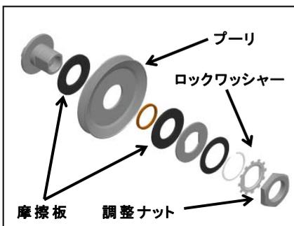
締め付けトルクの目安として調整ナットを手で力をかけずに軽くロックワッシャーにあたるまで締めて、スパナ(サイズ50)で1/3回転回して下さい。又、摩擦板は消耗品です。傷が付いたり厚みが1.6mmより薄くなったら交換して下さい。なお、交換・調整の際は、ご購入いただいた販売店へご相談ください。
