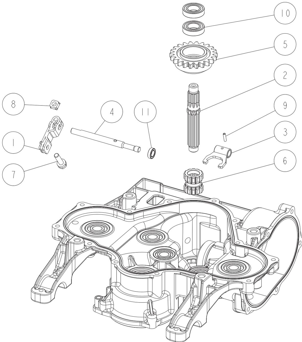
\*③,④,⑨はスプリングピンφ3→φ4に変更の為、0326-03000正逆切換セットで互換性あり
